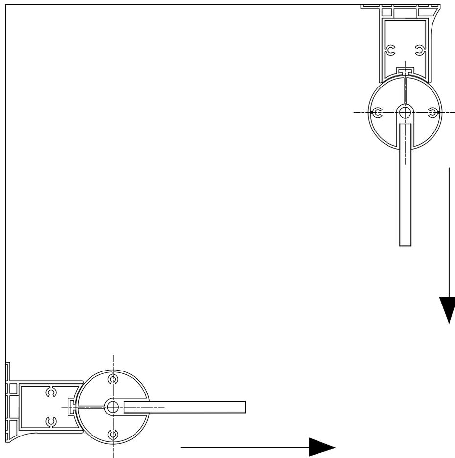
Регулировка осуществляется путем выдвигения профиля (максимально возможное выдвигение - 25 мм с каждой стороны).
