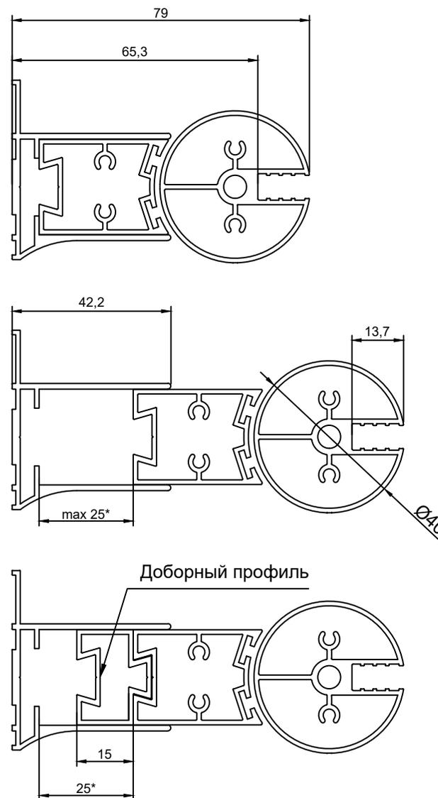
Регулировка осуществляется путем выдвижения профиля. Размеры указаны в мм.
