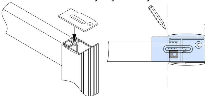
10.5 Установить заглушку обрезанной частью к стене. В зависимости от уровня выдвигения профиля, отметить и просверлить отверстие под второй саморез (устанавливается на усмотрение клиента).
