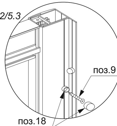
**6. Устанавливаем ролики на дверные полотна.**
