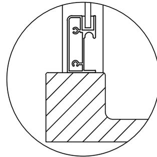
Установка ограждения производится по внутреннему краю бортика по рекомендации производителя.
