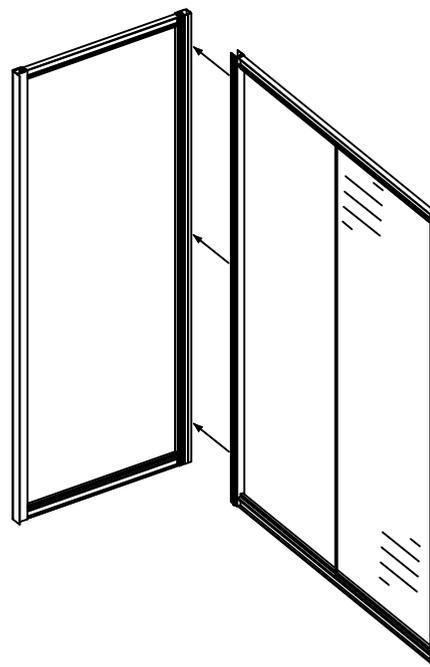
4. Равномерно по высоте распределить и просверлить отверстия в пристенных профилях (по 3 отверстия на каждый профиль).
