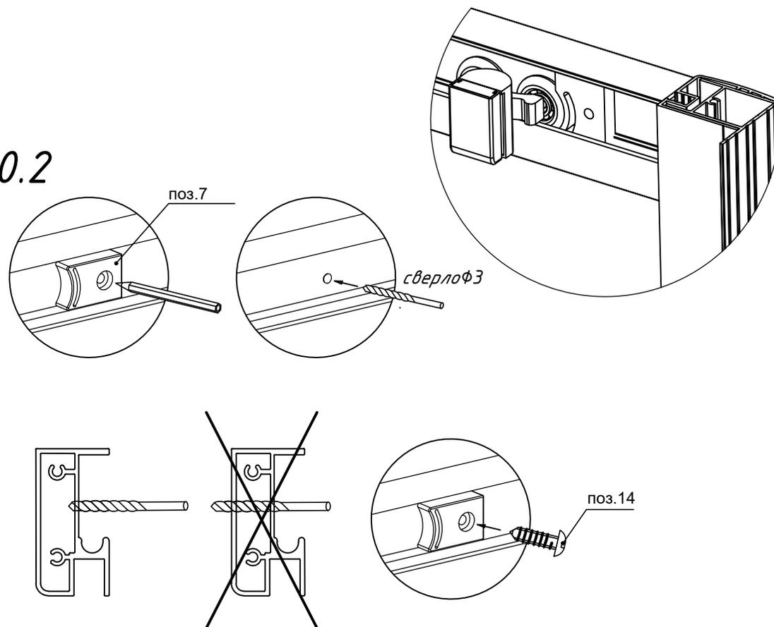
11.1 Перед установкой магнитного уплотнителя на дверь проверьте его полярность, присоединив его к магнитной полосе на профиле согласно рисунку.
