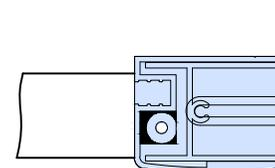
13.3 Обрезать заглушку до необходимого размера (\*при помощи ножовки по металлу).
