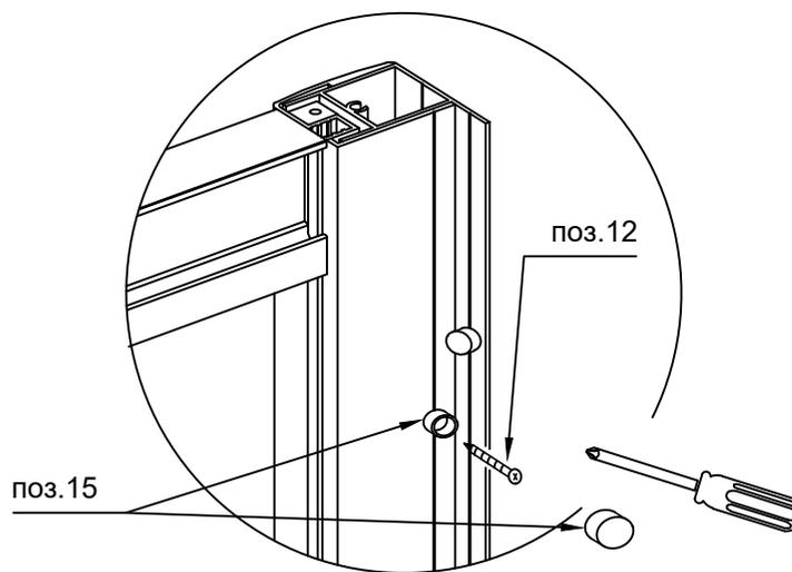
Необходимо предварительно разметить расположение крепежных элементов с расчетом на декоративные заглушки, закрывающие саморезы и заклепки, как показано на рисунке.
