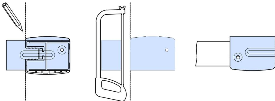
12.3 Обрезать заглушку до необходимого размера (\*при помощи ножовки по металлу).
