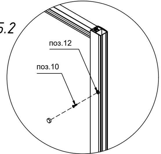
Необходимо предварительно разметить расположение крепежных элементов с расчетом на декоративные заглушки, закрывающие саморезы, как показано на рисунке.
